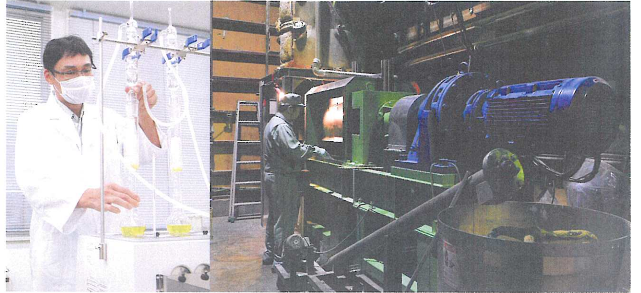
左/2020年9月に竣工した「R&Dセンター」での研究風景。同社の栄養補助食品「ハイブレフ」に含まれる油分の比率を測定するため、有機溶剤で油を分離する。この測定器で計測する。右/ハイブレフのもととなる米ぬかを絞る圧搾機。
