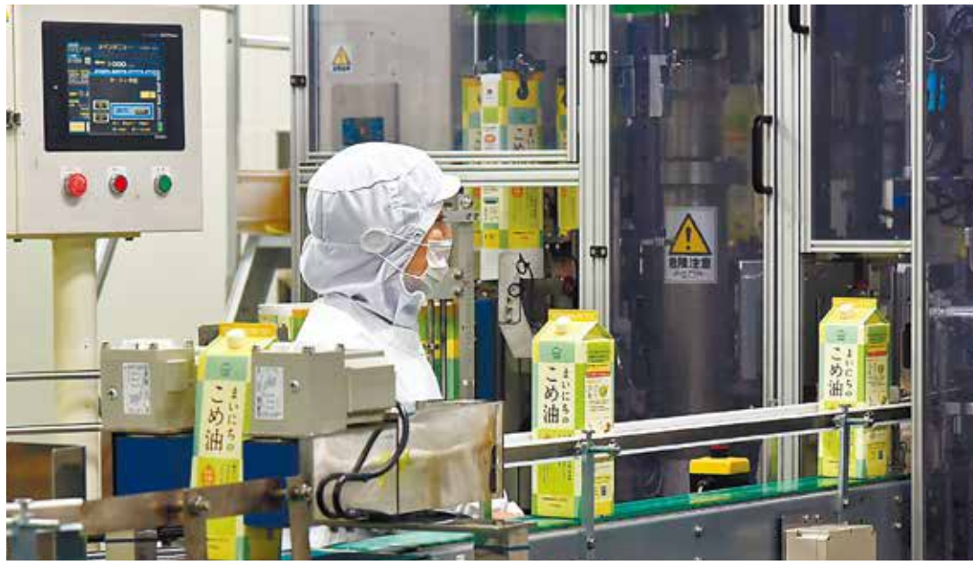
安全・安心に配慮した三和油脂の「こめ油」製造工程。パッケージングはクリーンルームで行われる
